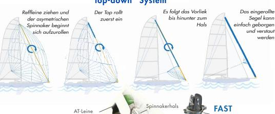
FX+ FAST: Freilaufadapter für asymetrische Spinnaker
